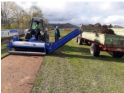
*Hier wird die erste Bahn abgefräst.*
