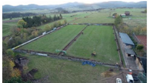
Außen um den Platz und einmal durch die Mitte laufen die Leitungen an insgesamt 15 Beregnungspunkte (3 auf der Mittelachse, 12 außen).
